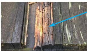
Bild 30-32: Faser vid utveckling av svampskador i träspån
