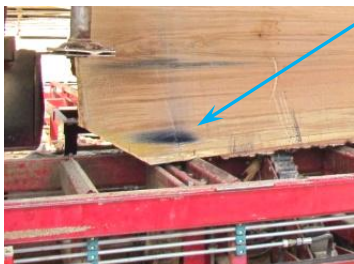
Bild 45: Järnspikar i ekträ
